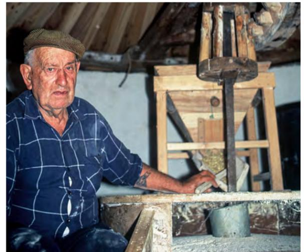
calha ou quelha que conduz o grão para o olho do moinho e o deposita na folga entre o poiso e o corredor
